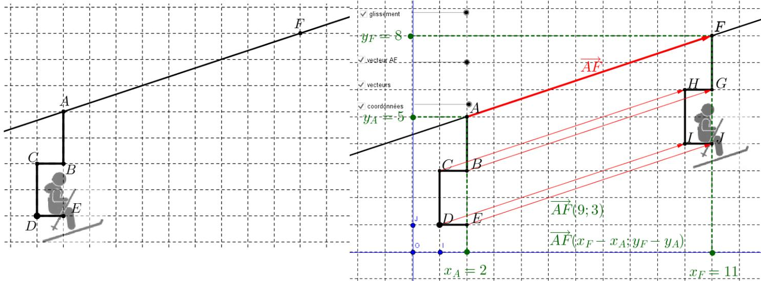
Le tracé de la cabine en position  $F$  peut être obtenu par un simple glissement le long de la droite  $(AF)$ , dans le sens de  $A$  vers  $F$  et de longueur  $AF$ .
