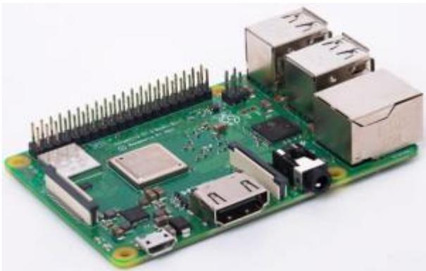
SoC combiné pour dynamiser le Raspberry Pi 3 modèle B+
